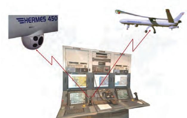
การควบคุม UAV และอุปกรณ์ (Payload) ในครัวเดียวกัน
