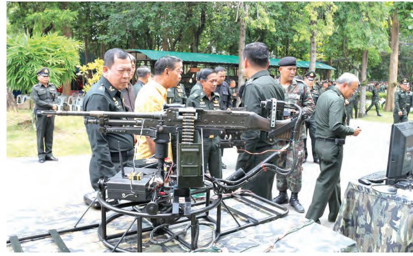
อยู่กับตัวปืนที่ใช้ทำการยิง โดยผู้ยิงจะอยู่ในที่ปลอดภัย และควบคุมฐานยิงผ่านเครื่องควบคุม(Joystick) ซึ่งมีทั้งแบบใช้สายและแบบไร้สาย ในส่วนของชุดไร้สาย สามารถควบคุมฐานยิงได้ระยะทางประมาณ 100 เมตร มีจอมอนิเตอร์สำหรับใช้เฝ้าดูผู้ยิงตรงข้าม และศูนย์หน้าเพื่อทำการเล็ง สำหรับส่วนประกอบของฐานยิงเป็นกลด้วยไฟฟ้า ประกอบด้วยส่วนหลัก 2 ส่วน คือ
