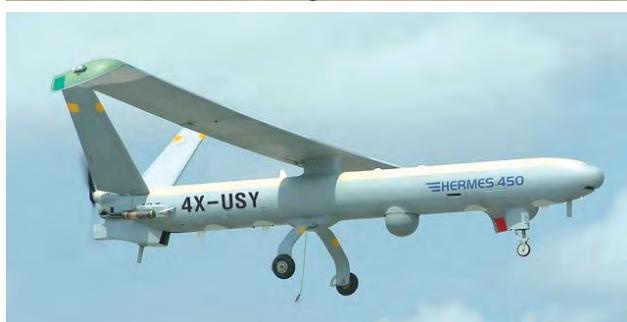
น้ำแข็งเกาะ พ่นด้วยน้ำมันโดยปฏิบัติงานได้ในอุณหภูมิตั้งแต่  $+55^{\circ}\text{C}$  จนถึง  $-30^{\circ}\text{C}$  เก็บรักษาได้ที่อุณหภูมิ  $+71^{\circ}\text{C}$  จนถึง  $-40^{\circ}\text{C}$  ขึ้น-ลงในขณะที่มีลมประทะทางข้างสูงสุด  $\pm 15$  knots (รวมลมกรรโชกแรงถึง 5 knots) ลมส่งท้ายสูงสุด 5 knot ลมประทะหน้าสูงสุด 20 knot (รวมลมกรรโชกแรงถึง 5 knots) ขึ้น-ลงอัตโนมัติโดยใช้ทางวิ่งขึ้น-ร่อนลง (Runway) ยาว 1,000 เมตร และกว้าง 30 เมตร
