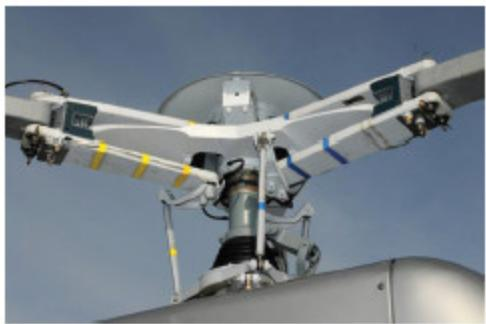
ใบพัดหลัก (Main rotor blades) และ SPHERIFLEX rotor head
