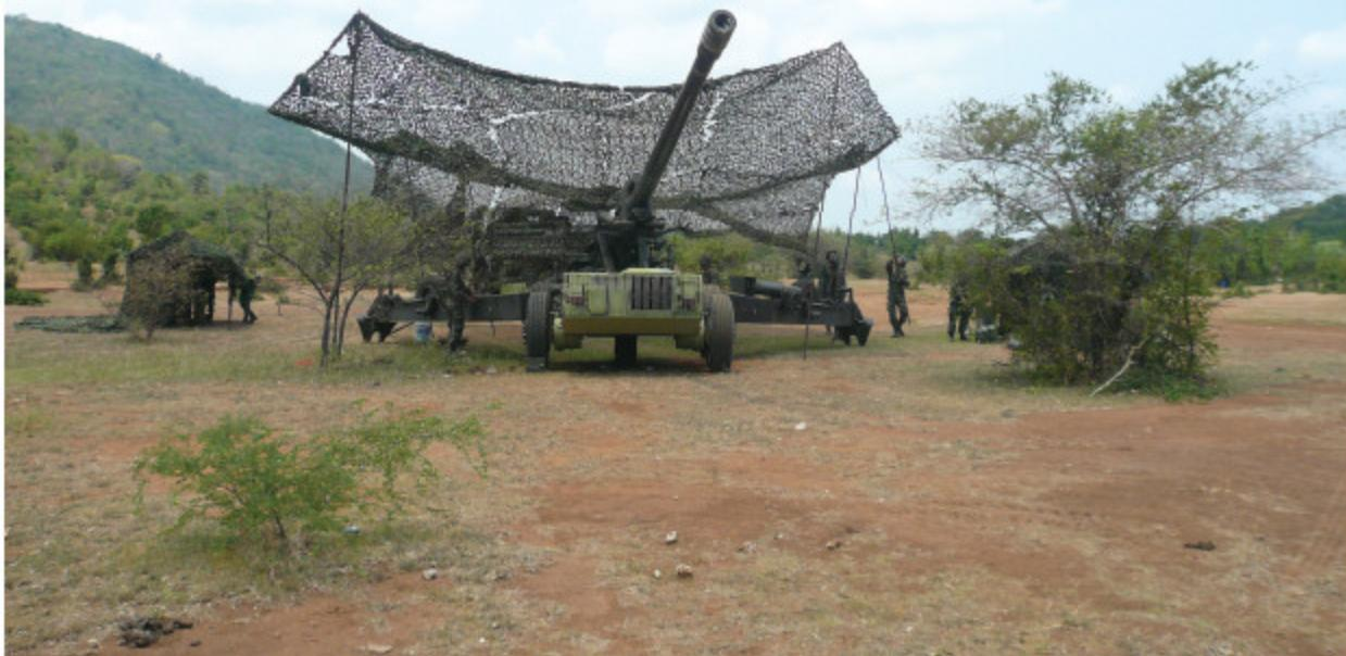
ในปี 2534 กองทัพนักได้จัดทำเป็นให้ถูกหนักกระสุน วิธีการ แบบ 34 ขนาด 155 มิลลิเมตร (ปืน 34 ขนาด 155 มม. / GHN-45) จำนวน 92 กระบอก และกองทัพเรือ 36 กระบอก จากบริษัท NORICUM ประเทศออสเตรีย เมื่อปีนั้นใหญ่ ที่สามารถดัดตั้งหน่วยช่วยขับเคลื่อน (APU/AUXILIARY PROPULSION UNIT) ได้โดยตัวโครงสร้างของปืนใหญ่อง ให้ออกแบบมาไว้รองรับการดัดตั้งเมื่อผู้ใช้ต้องการ เพื่อช่วย ให้สามารถเคลื่อนที่ไปปฏิบัติการทางยุทธวิธีได้สะดวก รวดเร็ว และคล่องแคล่วลงในภัยปะทะที่ยากลำบาก
