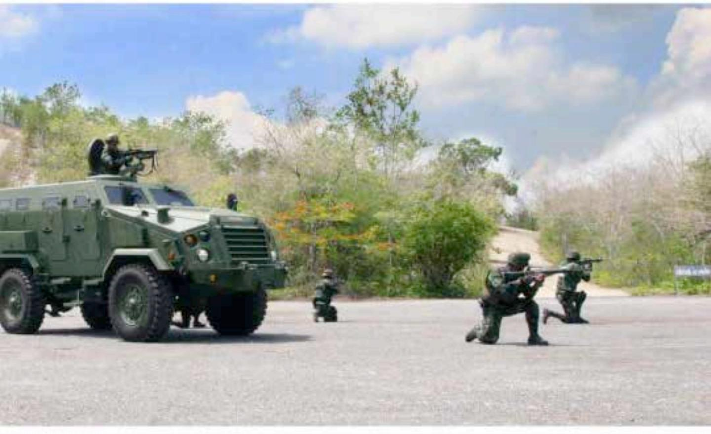
อาการสะเทือน ระบบไฟฟ้า 24 โวลต์ เครื่องกำเนิดไฟฟ้า 200 แอมป์เบร์ มีระบบล็อกเพียงท้าย (Differential lock) ระบบห้ามล้อนิวเมติก ติดตั้งก้านไฟฟ้าที่กันชนด้านหน้า
