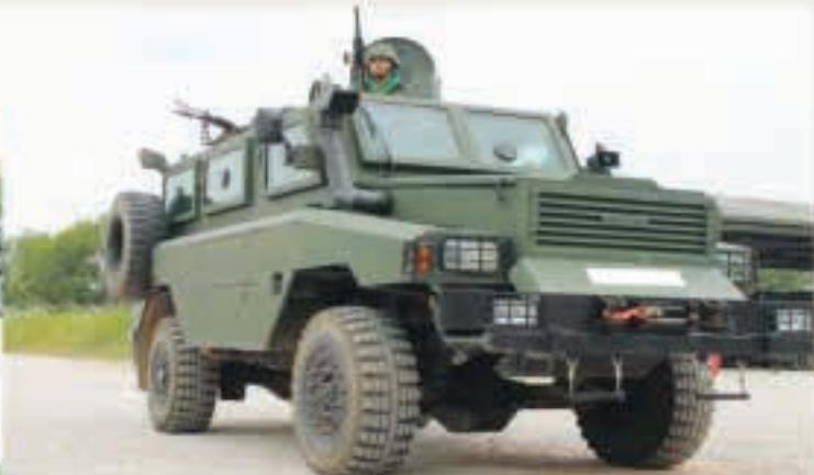
ตัวรถทำจากเหล็กเกราะตัดขึ้นรูปเป็นรูปตัววี (V) เพื่อหักเหแรงระเบิดสามารถป้องกันระเบิดได้ตามมาตรฐาน STANAG 4569 LEVEL 3
