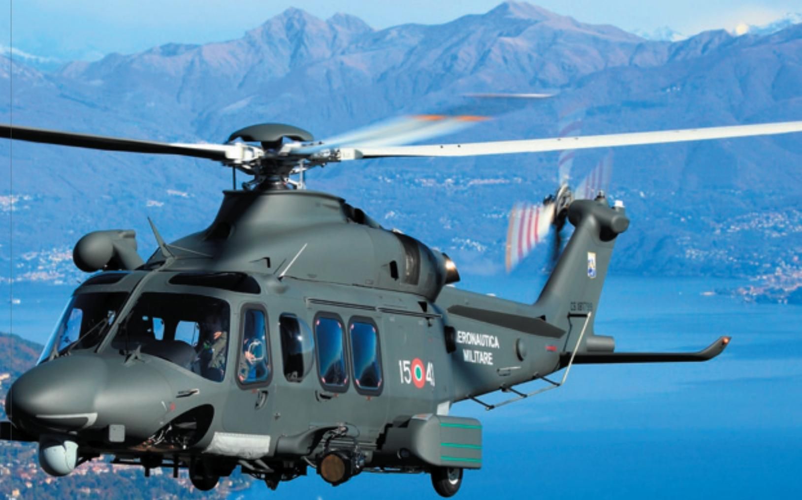
รุ่น AW139M เป็นรุ่นที่ปรับปรุงให้ใช้กับการกิจทางทหาร โดยติดตั้งอุปกรณ์เพิ่มเติม ได้แก่ อุปกรณ์การติดต่อสื่อสารทางทหาร V/UHF, HF, SATCOM, Tactical Data Link และ Video Down-Link เรดาร์ตรวจสภาพอากาศ, กล้องตรวจการณ์ Electro-Optical/Infra-Red, ติดเกราะในห้องนักบินและห้องโดยสาร, ปรับปรุงระบบฐานล้อ Landing Gear ให้มีความทนทานมากขึ้น, แทนติดตั้งอาวุธภายในและภายนอก (ปก.7.62 mm/ 12.7 mm/20 mm, อาวุธนำร่อง), อุปกรณ์เชือกและสลิงสำหรับรอยตัว
