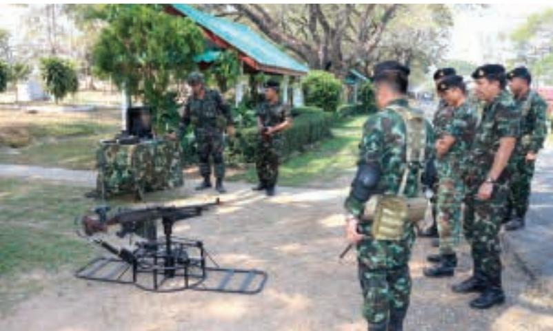
การใช้งานฐานยิงปืนกลด้วยไฟฟ้า สามารถนำไปติดตั้งไว้หลังบังเกอร์ วางสายควบคุมไว้ในห้องที่มิดชิด ปลอดภัย เมื่อเกิดการสู้รบจะเปิดชุดควบคุมแล้วทำการยิง อีกทั้งยังสามารถใช้เป็นเครื่องตรวจการณ์ได้อีกด้วย สิ่งประดิษฐ์ดังกล่าว นอกจากจะเป็นอุปกรณ์ที่ทำการยิงอยู่กับที่ได้แม้มีการตอบโต้จากฝ่ายตรงข้ามได้อย่างปลอดภัยและมีความแม่นยำแล้ว หน่วยประดิษฐ์ยังขยายผลด้วยการประดิษฐ์รถบังคับสำหรับวางฐานยิง เพื่อทำการบังคับเข้าไปยิงทำลายข้าศึกในระยะไกลได้อีกด้วย
