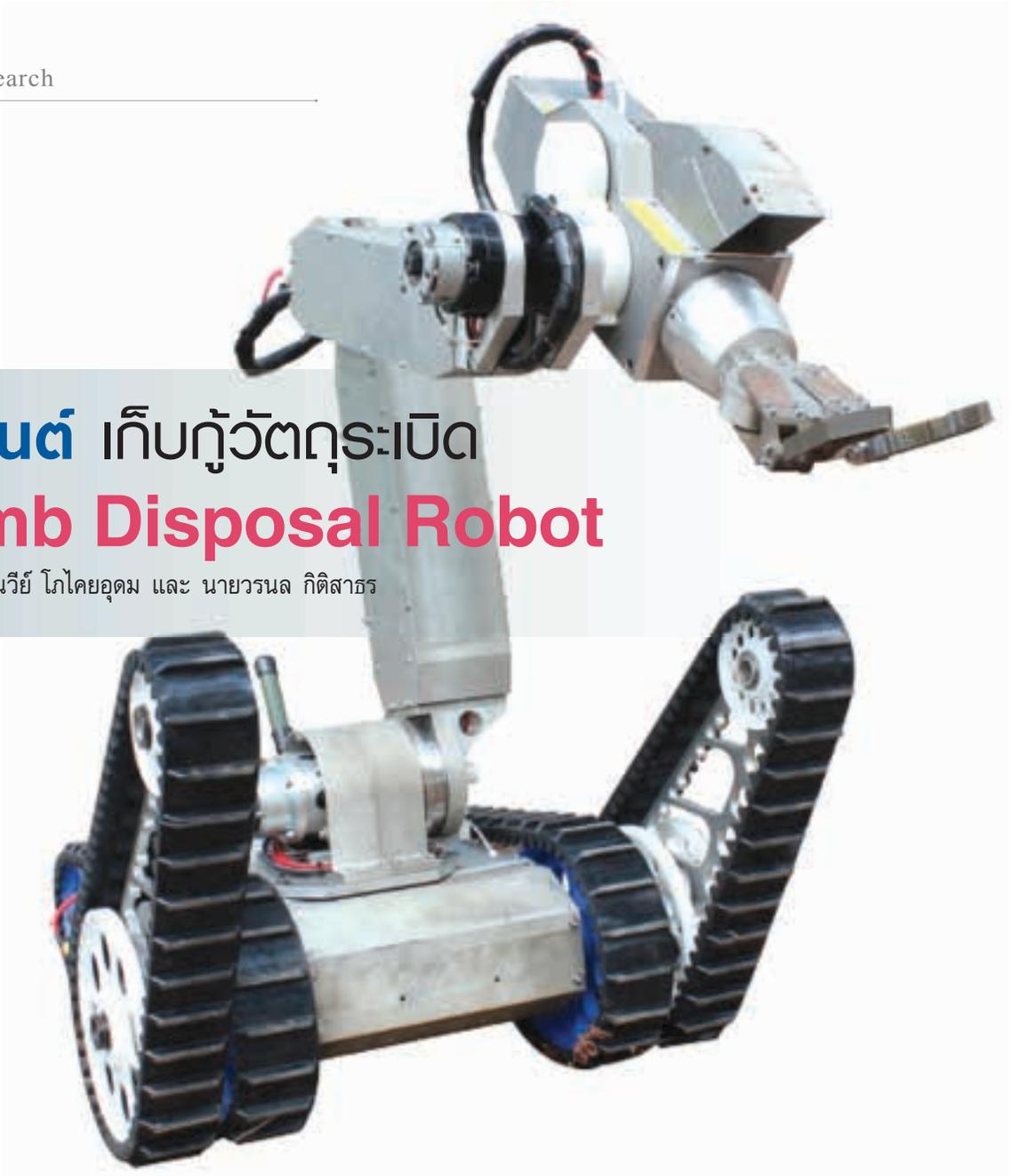
หุ่นยนต์เก็บกู้วัตถุระเบิด (Bomb Disposal Robot) คือหุ่นยนต์ที่ถูกออกแบบมาเพื่อใช้สำหรับงานเก็บกู้วัตถุระเบิดโดยเฉพาะ มีโครงสร้างหลักที่ทำงานถูกแบ่งออกเป็น 2 ส่วน คือ
