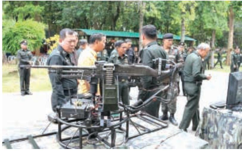
อยู่กับตัวปืนที่ใช้ทำการยิง โดยผู้ยิงจะอยู่ที่ปลอดภัย และควบคุมฐานยิงผ่านเครื่องควบคุม(Joystick) ซึ่งมีทั้งแบบใช้สายและแบบไร้สาย ในส่วนของชุดไร้สาย สามารถควบคุมฐานยิงได้ระยะทางประมาณ 100 เมตร มีจอมอนิเตอร์สำหรับใช้เฝ้าดูฝ่ายตรงข้าม และ ศูนย์หน้าเพื่อทำการเล็ง สำหรับส่วนประกอบของฐานยิงปืนกลด้วยไฟฟ้า ประกอบด้วยส่วนหลัก 2 ส่วน คือ
