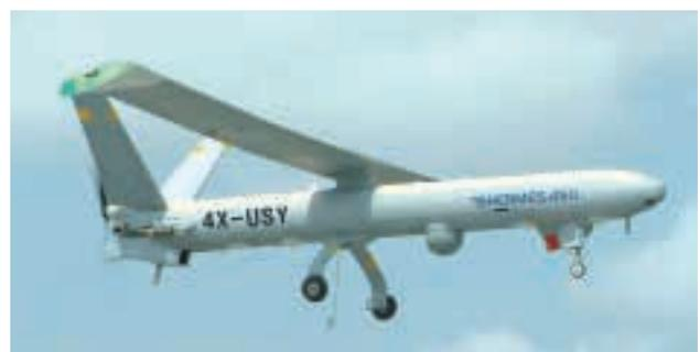
น้ำแข็งเกาะ ฟันด้วยน้ำมันโดยปฏิบัติงานได้ในอุณหภูมิตั้งแต่ +55°C จนถึง - 30°C เก็บรักษาได้ที่อุณหภูมิ +71°C จนถึง -40°C ขึ้น-ลงในขณะที่มีลมปะทะทางข้างสูงสุด ± 15 knots (รวมลมกรรโชกแรงถึง 5 knots) ลมส่งท้ายสูงสุด 5 knot ลมปะทะหน้าสูงสุด 20 knot (รวมลมกรรโชกแรงถึง 5 knots) ขึ้น-ลงอัตโนมัติโดยใช้ทางวิ่งขึ้น-รอนลง (Runway) ยาว 1,000 เมตร และกว้าง 30 เมตร
