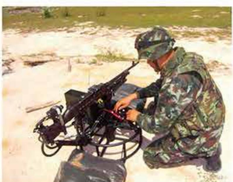
ฐานยิงปืนกลด้วยไฟฟ้า เป็นอุปกรณ์เมื่อประกอบเข้ากับอาวุธปืน โดยพลึงไม่ต้องประจำอยู่ที่ตั้งปืน สามารถวางสายควบคุมการยิงเข้ามา ที่อุปกรณ์ควบคุมการยิงซึ่งอยู่ห่างออกไป และที่ตัวปืนติดตั้งกล้องเพื่อให้ พลังสามารถตรวจการณ์ผ่านทางจอมอนิเตอร์
