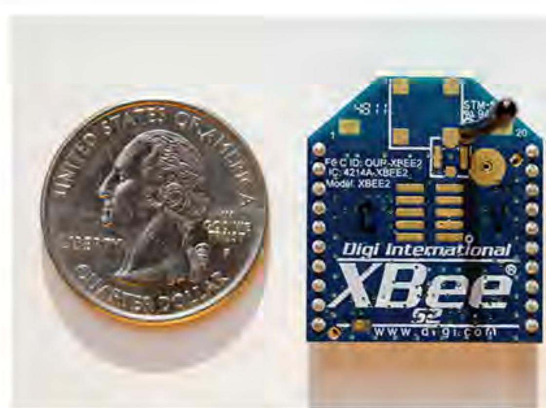
ตัวอย่างวงจรเซ็นเซอร์ขนาดเล็ก แบบ XBEE
