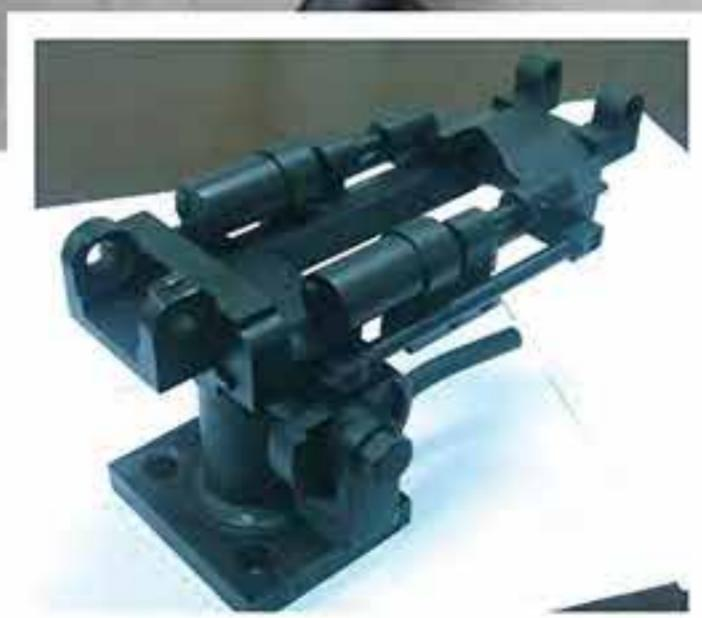
ข่ายปืนกล 38 MAG.58 พร้อมเครื่องรับแรงสะท้อน นอกจากใช้เป็นข่ายปืนแล้วยังสามารถรับแรงดึงของปืนด้วยสปริงร่วมกับระบบหน่วงการถอยของปืนด้วยการไถลเวียนของอากาศในระบบออกสูบ ซึ่งเป็นนวัตกรรมใหม่ ทำให้ผลการยิงมีความแม่นยำขึ้น
