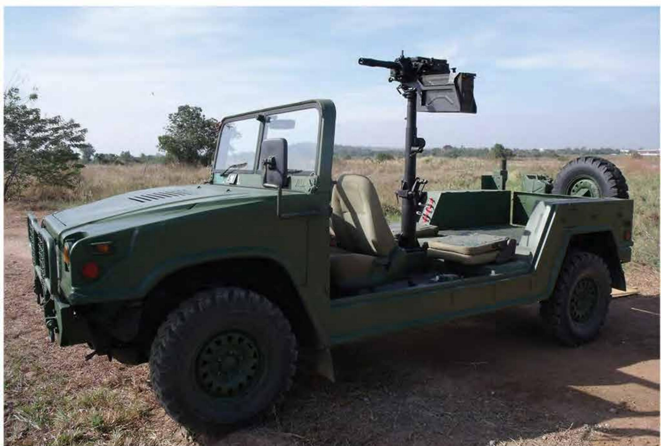
แท่นเครื่องยิงลูกกระเบิด เป็นเสาเหล็กบันแท่น ขนาด 40 มิลลิเมตร อัดโน้มติ บนรถยนต์บรรทุกแบบ 50 ใช้สำหรับติดตั้งอาวุธปืนบนยานพาหนะ สามารถหมุนติดตามเป้าหมายในทางทิศ และทางสูงได้สะดวก ทำให้การยิงมีความแม่นยำ และสามารถพับเก็บทำให้สะดวกต่อการเคลื่อนย้าย
